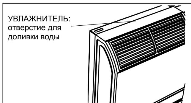
Рисунок 33 – РАСПОЛОЖЕНИЕ УВЛАЖНИТЕЛЯ И ОТВЕРСТИЯ ДЛЯ ДОЛИВКИ
