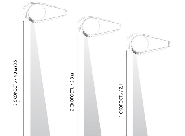
РИС. 2.2 ДЛИНА ПОТОКА ВОЗДУХА НА КАЖДОЙ СКОРОСТИ.
